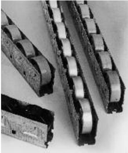
Il profilo Medirail è stato progettato per montare con estrema facilità le rotelle diametro 48 tipo RSR 48 in acciaio zincato, oppure tipo RSR 131 in materia plastica (Polipropilene). Questo sistema è la soluzione ideale per costituire corsie di scorrimento a gravità di colli leggeri e medi oppure per il contenimento laterale dei trasportatori. Inoltre trova ottima applicazione nei magazzini dinamici di stoccaggio e picking.
