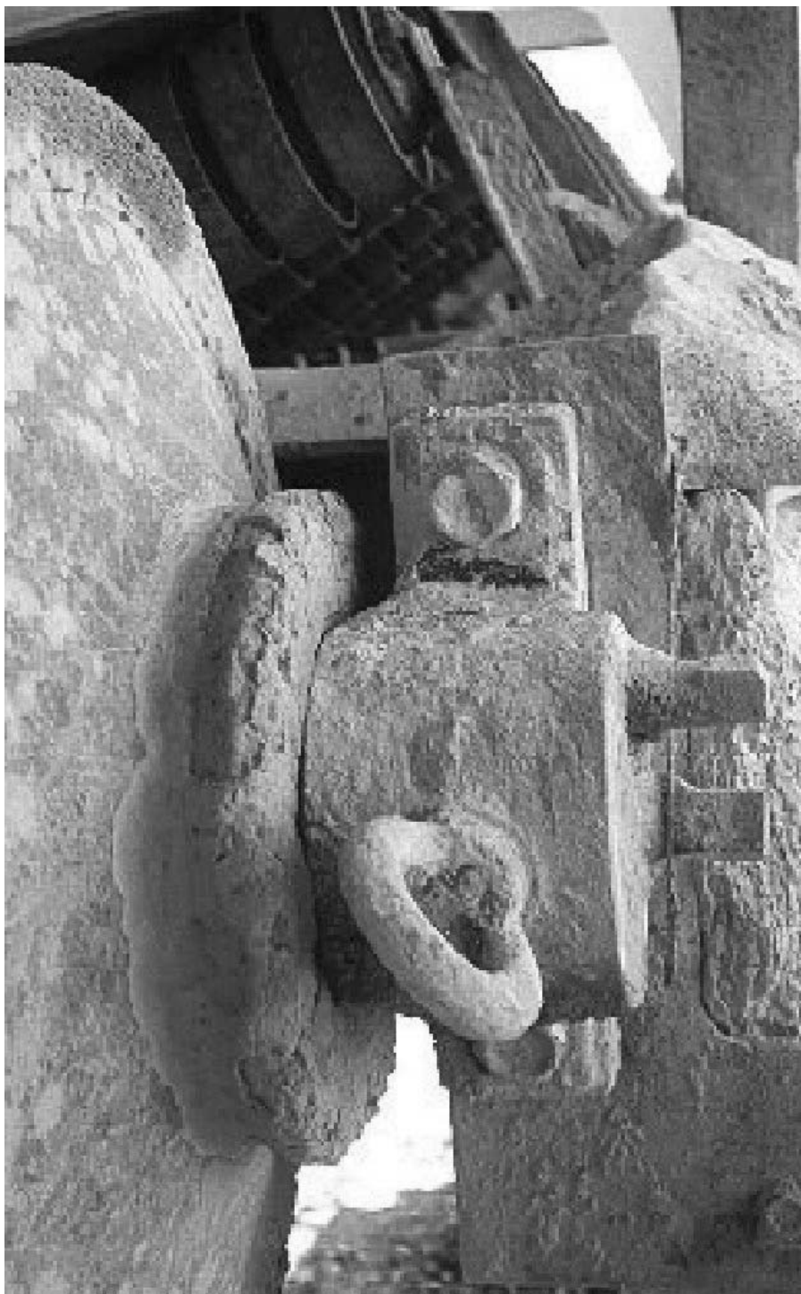
Applicazione: Fertilizzanti e potassio. Mototamburo ancora al lavoro dopo più di 30 anni in ambiente aggressivo.
