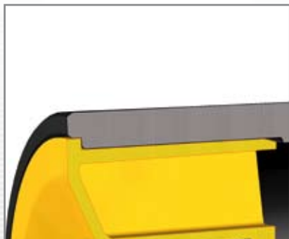
Tubo in Polietilene ad alta densità (HDPE), colore nero, lungo calettamento tra il tubo e la testata
