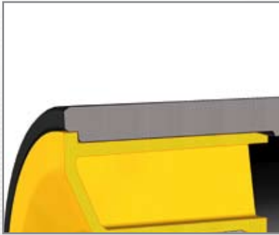
HDPE- Polyetyleenivaippa, väri musta, pitkä päädyn ja vaipan kiinnityspinta
