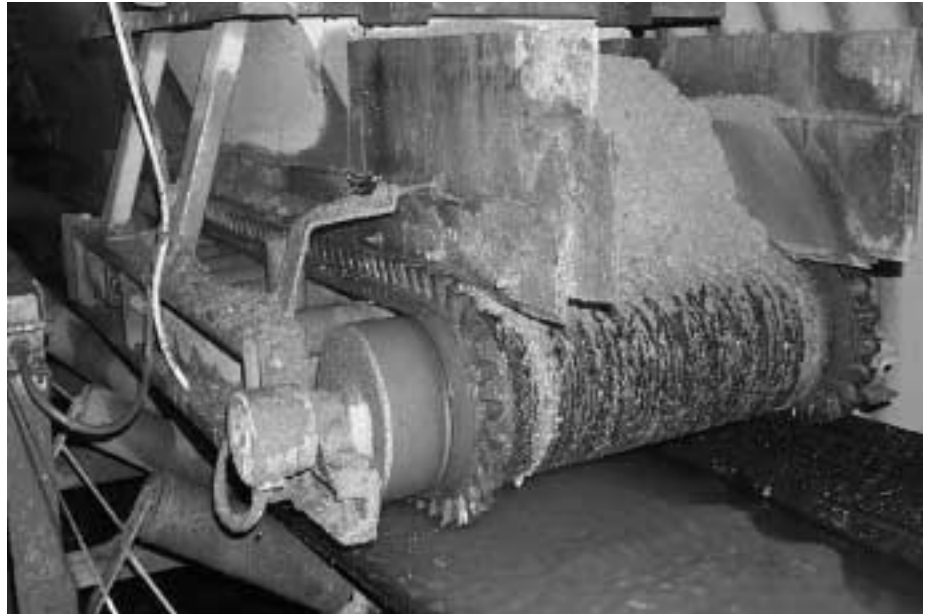
Afb. Grind- en zandwinning: een natte en fijnkorrelige aangelegenheid; hier bewijzen de voor nasmering geschikte labyrintafdichtingen hun deugdelijkheid.
